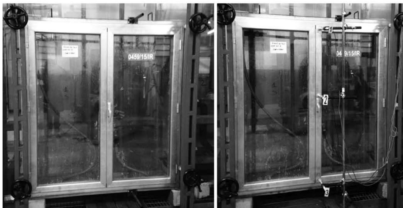
Foto 1 e Foto 2. Campione sottoposto a prova nell'assetto sperimentale prova e durante i test di resistenza al vento (prova di deformazione)
