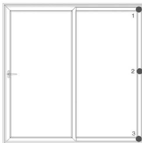
Fig. 13. Assetto sperimentale prova di resistenza al carico del vento: schema di posizionamento dei trasduttori (vista interna)
