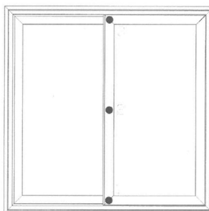
Fig. 6. Assetto sperimentale prova di resistenza al carico del vento: schema di posizionamento dei trasduttori (vista interna)
